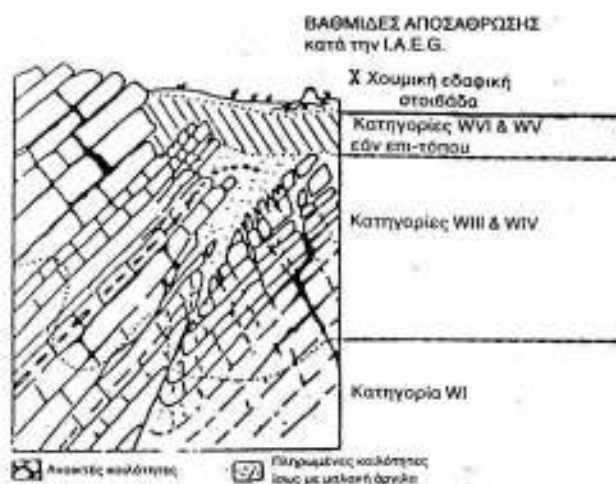
Σχ. 6. Τυπικό προφίλ αποσάθρωσης των ανθρακικών πετρωμάτων (κατά D. U. DEERE και F. D. PATTON 1971)
